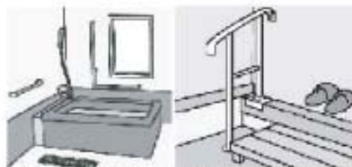
すべり防止や段差解消、手すりの取り付け工事
