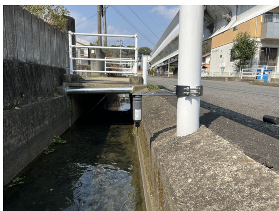
写真 3-2-4 浸水センサー
