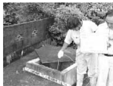
井戸の水位測定状況
