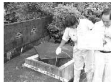
井戸の水位測定状況
